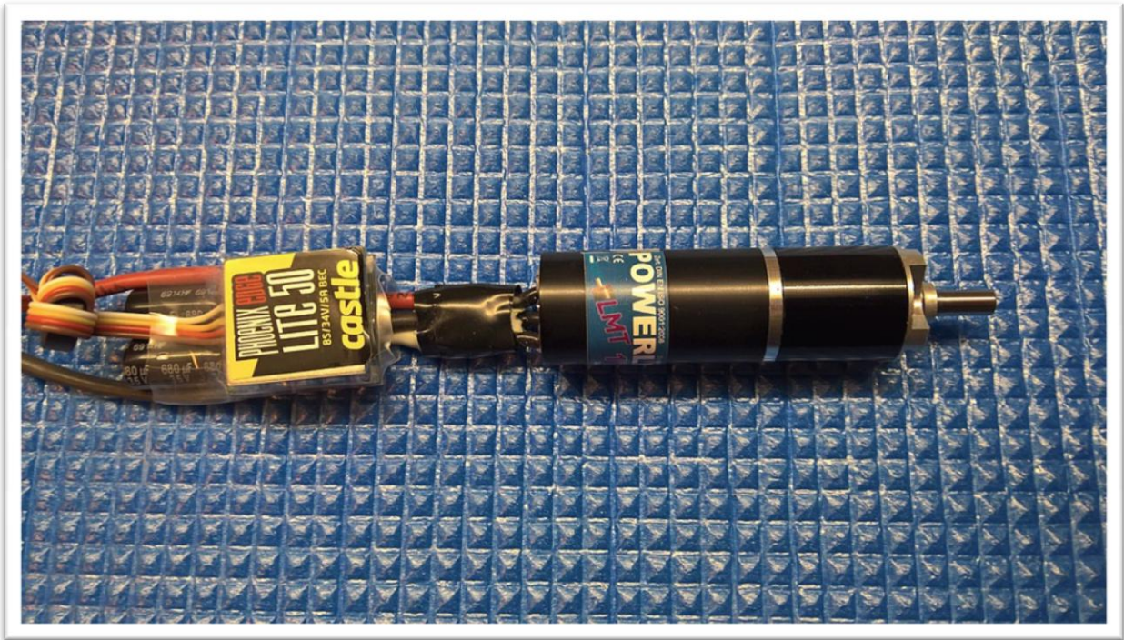
Motor und Regler verlötet, mit 5Min. Epoxi vergossen und mit Isolierband umwickelt.
