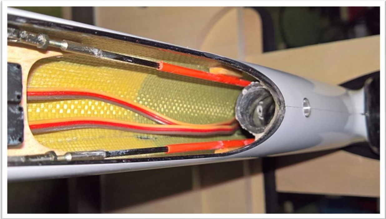
Bodenzugröhrchen an der Rumpfwand abgestützt.
