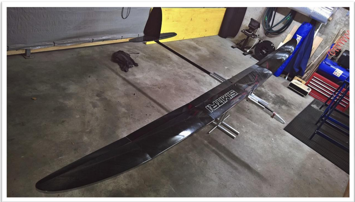
Das ganze Equipment provisorisch im Rumpf und auf der Schwerpunktwage die Einbauposition bestimmen. Mein Schwerpunkt liegt 107mm hinter Flügelkante neben dem Rumpf.
